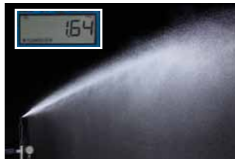
Difusor de la competencia sin PRS con tobera 15Q y presión de entrada de 5,4 bar. Sin PRS, el caudal ascendió a 6,21 litros por minuto.
