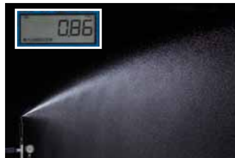
Difusor 1800 PRS con tobera 15Q y 5,4 bar de presión de entrada. Caudal regulado por el PRS a 3,26 litros por minuto.
