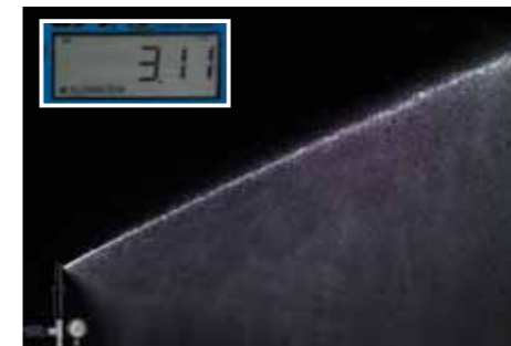
Aspersor 5000 PRS Rotor con tobera de 11,36 l/min y presión de entrada de 5,4 bar. Caudal regulado por el aspersor PRS a 11,77 litros por minuto.
