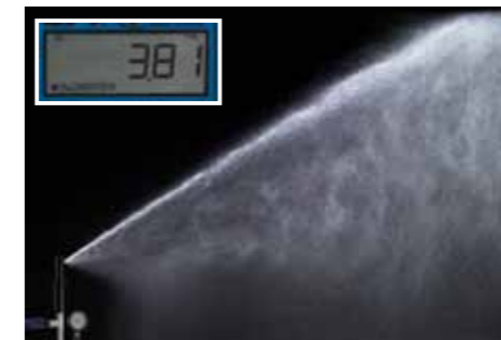
Aspersor no PRS de la competencia con tobera de 11,36 l/min y presión de entrada de 5,4 bar. Sin PRS, la presión subió a 14,42 litros por minuto.
