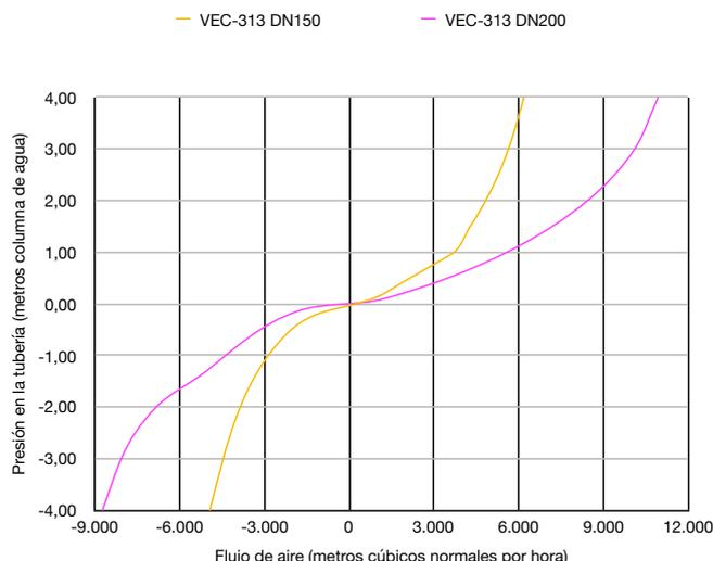
Los diagramas de alivio y admisión de aire están basados en mediciones reales para válvulas de aire durante el año 2018 en el banco de pruebas de Bermad. El banco ha sido diseñado conforme a la normativa EN-1074/4 y está homologado con conformidad a la normativa AS-4956 (2008). Recomendamos el uso del programa de cálculo Bermad Air ([www.bermad-air.com](http://www.bermad-air.com)) para optimizar el dimensionado y posicionar correctamente las ventosas en la conducción.
